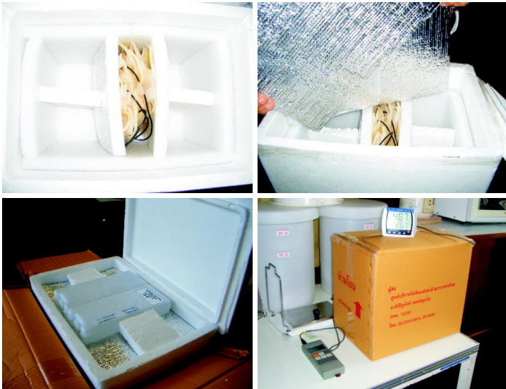
รูปที่ 4 รูปแบบการบรรจุ PC จำนวน 12 ยูนิต ในกล่องขนาด M โดยใช้ IP ชนิด อุณหภูมิ -3^{\circ}\text{C} ขนาด 0.5 กก. จำนวน 2 ก้อน และใช้โฟม Polyethylene เคลือบ aluminium (FAL) ความหนา 20 มม. จำนวน 7 ชั้น ความหนา 15 มม. จำนวน 1 ชั้น และ ความหนา 3 มม. จำนวน 1 ชั้น เป็นฉนวน สามารถรักษาอุณหภูมิให้อยู่ในช่วง 20 - 24^{\circ}\text{C} นาน 16.58 - 21.00 ชั่วโมง เมื่อทำการทดลอง ติดต่อกัน 3 ครั้ง
