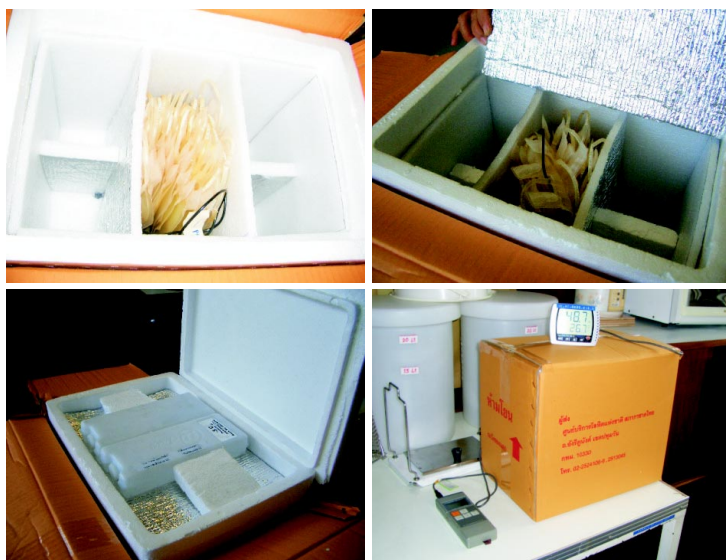
รูปที่ 3 รูปแบบการบรรจุ PC จำนวน 25 ยูนิต ในกล่องขนาด M โดยใช้ IP ชนิดอุณหภูมิต่ำ -3^{\circ}\text{C} ขนาด 0.5 กก. จำนวน 2 ก้อน และใช้โฟม Polyethylene เคลือบ aluminium (FAL) ความหนา 10 มม. จำนวน 8 ชั้นเป็นฉนวน สามารถรักษาอุณหภูมิให้อยู่ในช่วง 20 - 24^{\circ}\text{C} นาน 20.17 - 24.00 ชั่วโมง เมื่อทำการทดลองติดต่อกัน 3 ครั้ง
