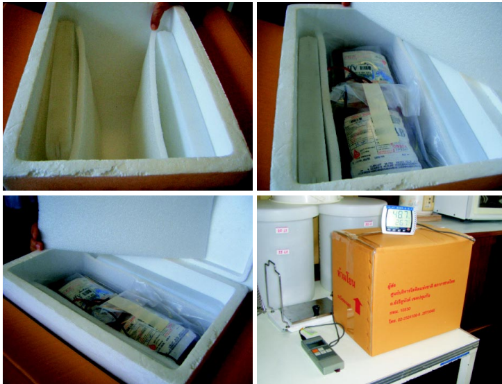
รูปที่ 2 รูปแบบการบรรจุ PRC จำนวน 10 - 15 ยูนิต ในกล่องขนาด M โดยใช้ IP ชนิด อุณหภูมิ -3°C ขนาด 2.2 กก. จำนวน 2 ก้อน ใช้โฟมธรรมชาติ (F) และโฟม Polyethylene เคลือบ aluminium (FAL) ความหนา 20 มม. จำนวนชนิดละ 2 ชั้น สามารถรักษา อุณหภูมิให้อยู่ในช่วง 2 - 10°C นาน 23.50 ชั่วโมงขึ้นไป เมื่อทำการทดลองติดต่อกัน 3 ครั้ง
